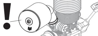
The engine must never be run without the air filter in place! Der Motor darf niemals ohne Luftfilter betrieben werden. Le moteur ne doit jamais tourner sans que le filtre à air soit en place.
