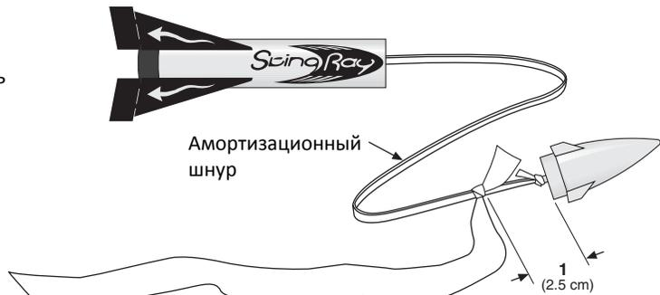
**B.** Двойным узлом привяжите шлейф к амортизационному шнуру на расстоянии 2,5 см от носовой части.
