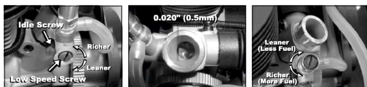
Винты регулировки карбюратора
