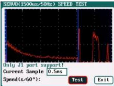
**Speed Test:** Нажмите кнопку "Test" для чтения тестовых кривых и тестовых результатов.
