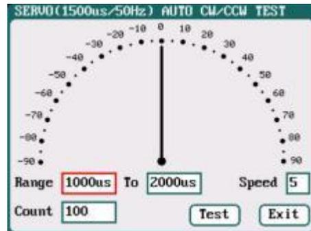
**Auto CW/CCW Test:** Нажмите кнопку "Test", затем указатель отклоняется на указанное время с указанной скоростью вперед и назад между указанными значениями, и сервопривод откликается соответственно.
