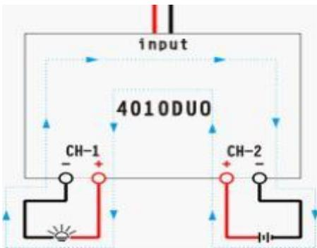
Примечание: “Channel Regenerative Mode” предназначен для разряда из одного канала в другой канал, текущая версия поддерживает только разряд через нагрузочный резистор и лампы, но следующие версии будут поддерживать регенеративный разряд в батарею. Пройдите в MEMORY SETUP → Discharge → Regenerative Mode для выбора режима “To channel” (В канал).
