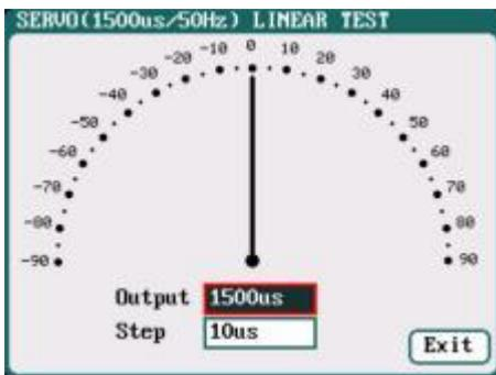
**Linear Test:** При повороте ручки-ролика, указатель отклоняется на величину "Step", и сервопривод откликается соответственно.
