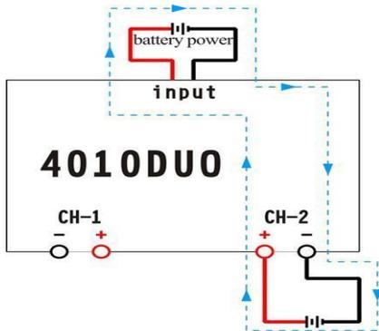
Примечание: “Power Regenerative Mode”: это когда источник питания зарядного устройства действует как “батарея”, зарядное устройство будет регенеративно заряжать "батарею" во время разряда батареи. Пройдите в MEMORY SETUP → Discharge → Regenerative-Mode для выбора режима “To input” (В источник питания).
