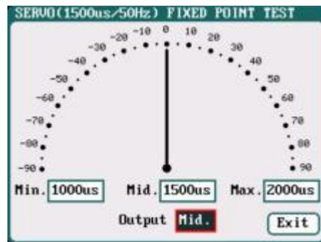
**Fixed Point Test:** При повороте ручки-ролика, указатель отклоняется между каждым значением, и сервопривод откликается соответственно.
