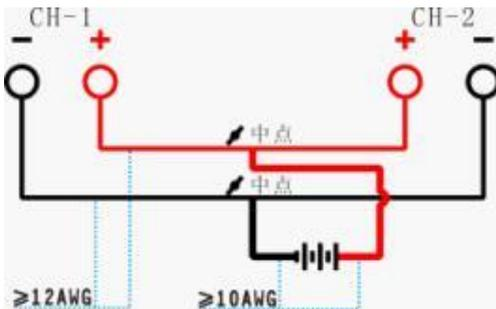
Примечание: При заряде от двух каналов батарея должна быть подключена как показано на Рисунке 3 и два канала должны работать в синхронном режиме, в противном случае зарядное устройство будет повреждено.
