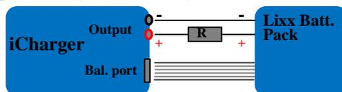
В этом режиме, литиевая батарея разряжается через iCharger и нагрузочное сопротивление R,  $P = P_i + P_r$ , ( $P_i$  - мощность разряда зарядного устройства;  $P_r$  - рассеиваемая мощность внешнего сопротивления).  $P_i$  ограничена максимальной мощностью разряда зарядного устройства.
