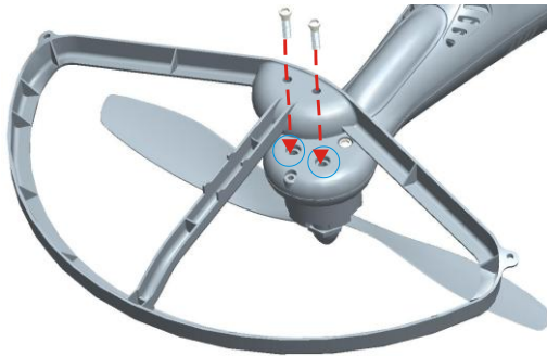
Fig.1 Prop Guard Installation Diagram /图 1 桨保护器安装示意图
