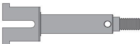
86249 a Усиленный вал 8x11x59mm
