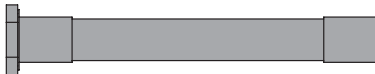
86090 x2 Steering Crank Post 6x49mm Lenkungspfosten Axe pour direction ステアリングクランクシャフト
