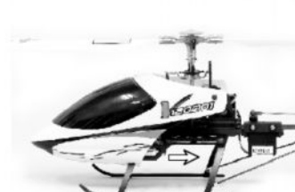
Шаг 3: Снимите кабину и выньте батарею.
