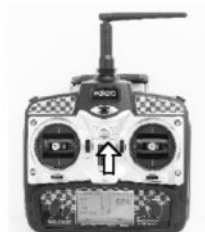
Поставьте ручку и триммер газа в нижнее положение. Остальные триммеры поставьте в нейтральное положение.
